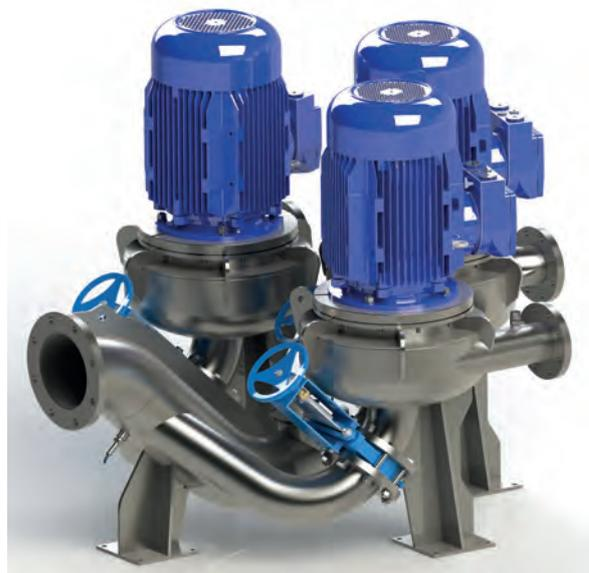
Nouveauté 2019, un DIP Système avec trois pompes : l'une en service, une autre en cascade, et une autre pouvant être utilisée en secours ou pour proposer un débit encore plus important.
